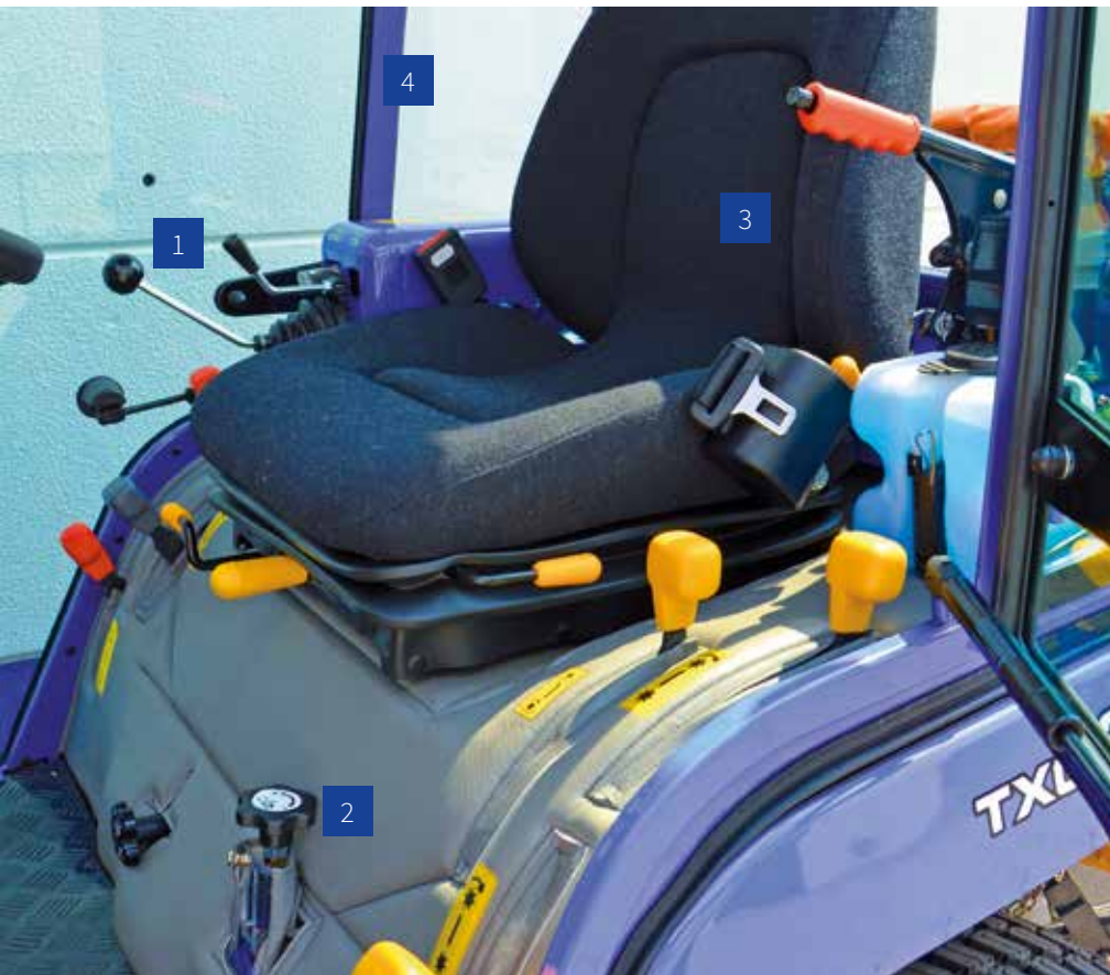
Die Joystick-Kommandozentrale zur kompletten Hydrauliksteuerung.
