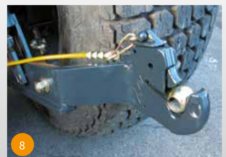
Schnellwechsel-Fanghaken zum flinken und sicheren Wechsel der Anbaugeräte (optionale Ausrüstung).
