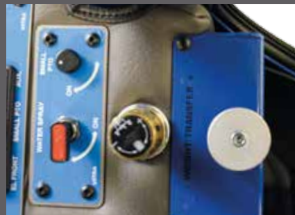
Durch das optionale Gewichtstranferventil kann der Auflagedruck der Frontanbaugeräte stufenlos eingestellt werden.
