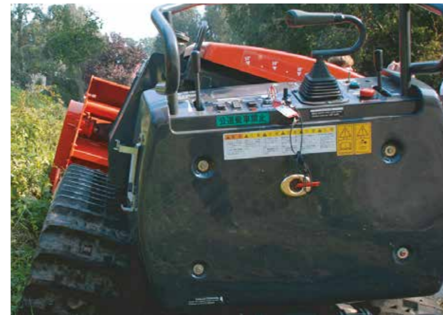
selbstnivellierender Führerstand (gewährleistet Standsicherheit des Fahrers an extremen Schräglagen)
