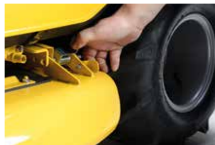
Schnellverschluss zum Abklappen der Mähwerksflügel
