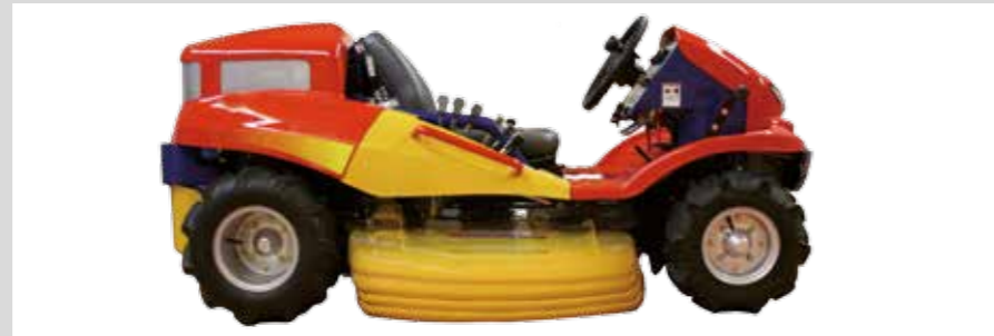
Schnitthöhen von 0 bis 150 mm (21-stufig) einstellbar
