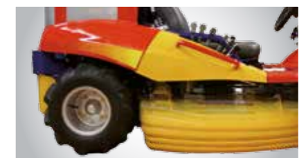
Schnitthöhe von 0 - 150 mm (21-stufig).
