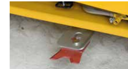
werkzeugloser Messer-Wechsel (außer Modelle CM 1401, CMX 1402)
