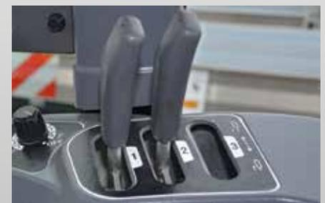
Werkseitig verfügt die neue TJA-Serie über ein ergonomisches Kreuzhebel-Steuergerät (2 Funktionen) sowie zwei Zusatz-Steuergeräte.
