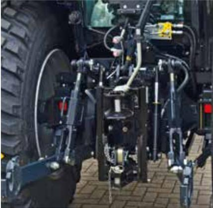
Die leistungsfähige Hydraulik-Anlage arbeitet mit 66 L/min. Ölmenge. Mit 196 Bar Druck kann über den Heckkraftheber der Baugröße 2 ein Gewicht von bis zu 4100 kg (Modell TJA 8100) gehoben werden.
