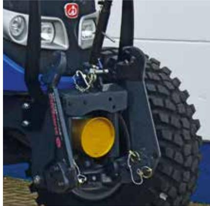
Der robuste Frontkraftheber bietet eine beeindruckende Hubkraft bis zu 1.800 kg. Die Unterlenker sind mit Schnellkupplern ausgerüstet und können bei Bedarf hochgeklappt werden. Die äußerst stabile Frontzapfwelle bietet einzigartigen Komfort beim Anstecken der Gelenkwelle (Bcon-System). Optional ist eine kommunale Anbauplatte erhältlich.
