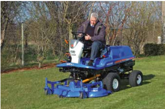
Reines Mähgerät ohne Grassammelbehälter und Absaugturbine
