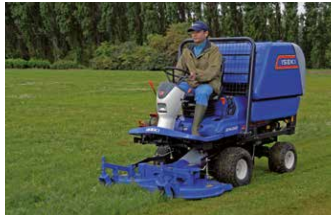
Mit Grassammelbehälter und leistungsstarker zentraler Absaugturbine
