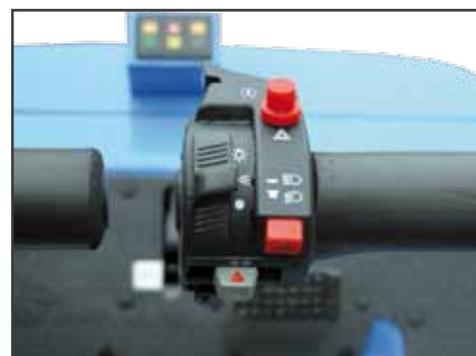
Die Steuerung der Beleuchtungsanlage erfolgt durch einen ergonomischen Spezialschalter am Lenkhebel.
