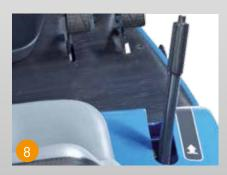
Hebel zur Betätigung der Reinigungsklappe am Sammelbehälter.
