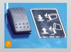
Komfortable Behälterentleerung durch einen Wippschalter im Fahrersitzbereich (nur Modell mit elektrohydraulischer Funktion). Modell mit mechanischer Funktion siehe Seite 8.
