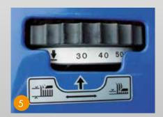
Schnellverstellung des Mähwerks in 6 möglichen Stufen: 30, 40, 50, 60, 70 und 90 mm.
