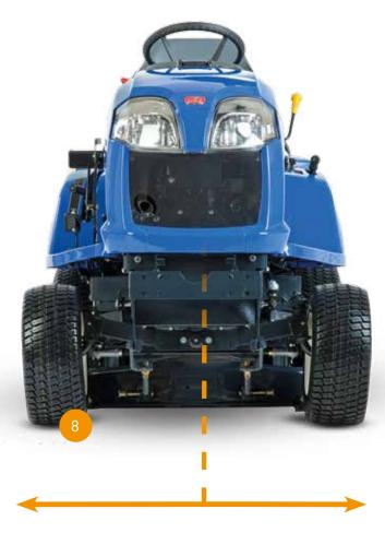
Durch die zentrale Position des Mähdecks können links- und rechtsseitig Mähkanten perfekt ausgemäht werden.
