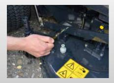
Am Mähwerk befinden sich jeweils rechts- und linksseitig Federbolzen, die werkzeuglos herausgezogen werden können. Das Mähwerk kann damit schnell und einfach vom Fahrzeug demontiert werden.
