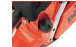
Bequemes Betanken durch senkrechten **Kraftstoff-Einfüllstutzen**.
