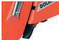
Optimaler Spanauswurf verhindert Verstopfung, auch bei langen Spänen.
