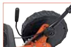
3-stufig höhenverstellbarer Holm für unterschiedliche Körpergrößen.
