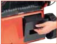
Für den schnellen Umbau zum Mulchen ist im Lieferumfang des PM5101S3R und des PM5600S3C ein **Mulchkeil** enthalten.
