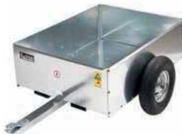
Einfaches Beladen durch niedrige Bauhöhe, verzinktes Stahlblech, Zuladung bis 200 kg, Rückwand herausnehmbar.
