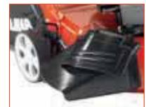
Zusätzlicher verschleißbarer **Seitenauswurf**.
