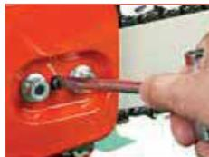
**PS500C und PS550** Seitliche Kettenspannung **PS550** zusätzlich verliersichere Muttern
