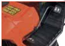
Stufenloses Hydrostatikgetriebe für Rückwärtsfahrt mit einfacher Fußhebelbedienung.
