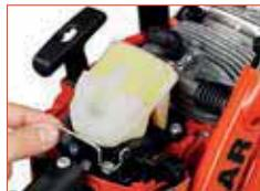
**PS500C und PS550** Günstig ausgelegter Kettenraum erlaubt hervorragenden Spanauswurf und bequeme Reinigung
