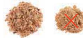
Eine gute Schnittleistung der Motorsäge wird nur mit einer scharfen Sägekette erzielt. Denn scharfe Sägezähne produzieren große Späne. Werden die Späne beim Arbeiten immer kleiner bzw. so fein wie Sägemehl, ist dies ein sicheres Zeichen für eine stumpfe Sägekette. Stärkeres Drücken beim Sägen hilft nicht, sondern erhöht nur den Verschleiß von Kupplung, Schiene und Kette.
