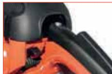
**PS500C und PS550 Touch&Stop:** Motor stoppt nach kurzem Antippen des Hebels und steht immer auf Betrieb. Klare Stellungen für Kaltstart, Betrieb und Stopp.
