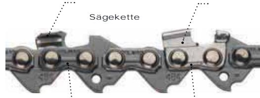
**Verbindungsflasche:** Ölfangtasche transportiert Sägekettenöl zu den Nietverbindungen und verteilt es gleichmäßig an die beweglichen Teile.
