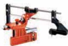
Das Feilgerät Super Rapid wird auf die Schiene geklemmt und die Rundfeile wird in eine bewegliche Führung eingespannt. Winkel und Eindringtiefe der Rundfeile werden am Gerät eingestellt. Auch für Ungeübte eine gute Möglichkeit, die Sägekette richtig zu schärfen.
