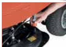
Wasseranschluss für schnelle Mähdeckreinigung.
