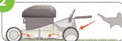
**Mulchmäher:** Entfernen Sie den Grasfangsack und den Seitenauswurf und stecken Sie den Mulchkeil auf. Dadurch wird auch die Geräuschemission verringert.
