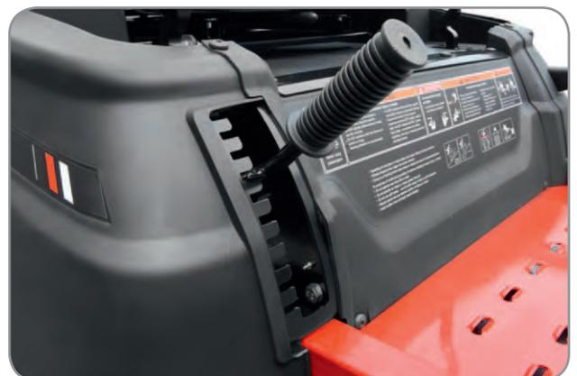
Einfach zu bedienende Schnitthöhenverstellung in zehn Stufen
