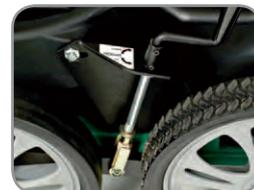
Stufenlose Höheneinstellung über Spindel.
