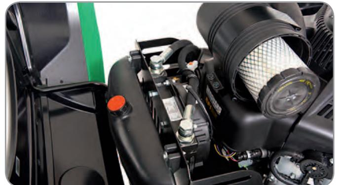
Großdimensionierter Hydraulikölkühler in Verbindung mit leistungsstarkem Lüfter.
