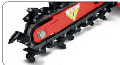
Robuste gehärtete Fräszähne für langen, störungsfreien Einsatz.
