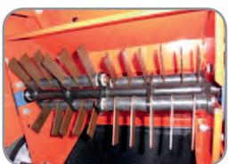
Am Fliehkraftsystem aufgehängte gehärtete 3 mm Vertikutiermesser.
