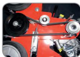
Langlebiger Messerwellenantrieb mit kugellagerter Metallspannrolle. Doppelriemen
